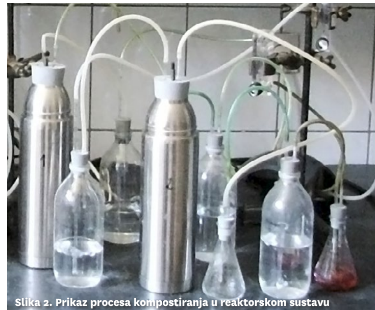
Slika 2. Prikaz procesa kompostiranja u reaktorskom sustavu
